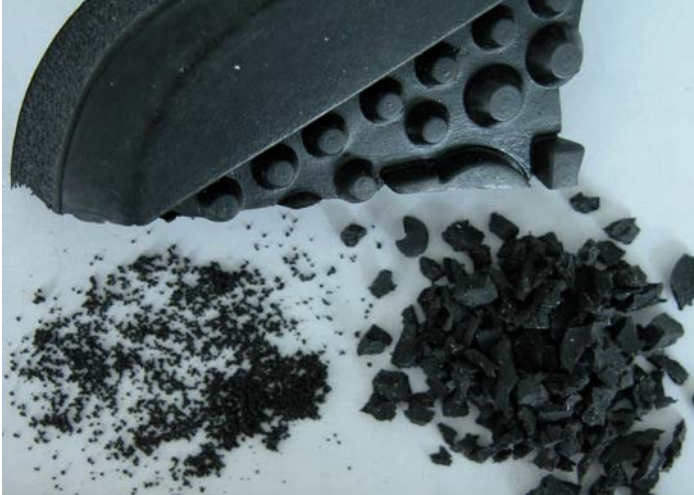
Ergebnisse der Vor- und Feinzerkleinerung einer Gummischuhsohle
