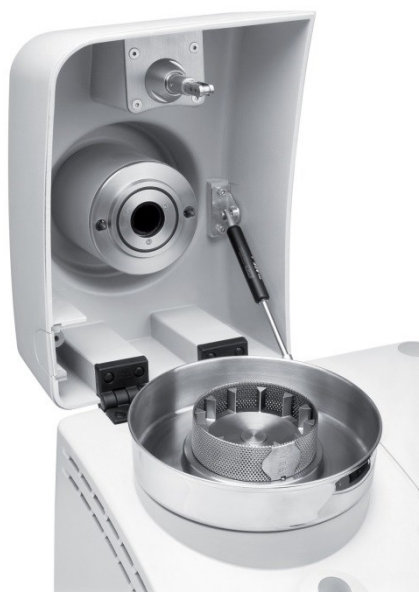
Abb. 2: In der Ultra-Zentrifugalmühle ZM 200 wird die Probe zwischen Rotor und Ringsieb zerkleinert
