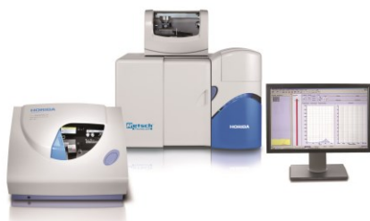
Abb. 1: HORIBA SZ-100 (links): Photonenkorrelationsspektrometer, Messbereich 0,3 nm bis 8 µm, mit Option für Zeta-potentialmessung und HORIBA LA-950 (rechts): SLS Gerät für Nass- und Trockenmessung, Messbereich 10 nm bis 3000 µm
