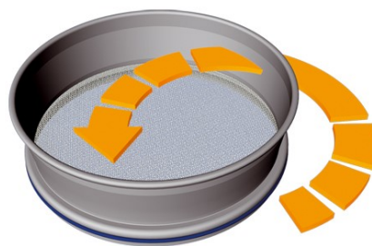
Abb. 4: Prinzip der Plansiebung
