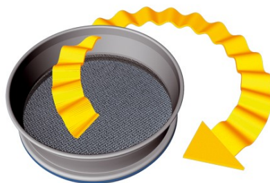
Abb. 6: Prinzip der Klopf-siebung
