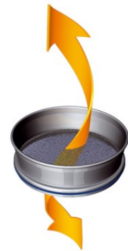
Abb. 2: Prinzip der Wurfsiebung
