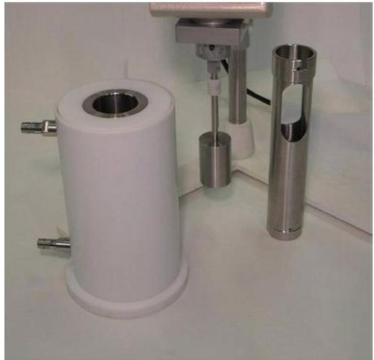
Abb.1: Laborviskosimeter Rheomat R 180
