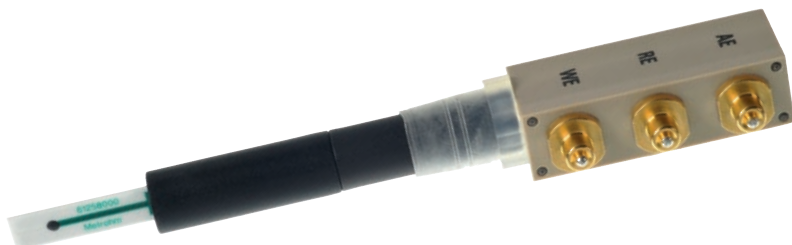
Abbildung 3. Die scTRACE Gold, bestehend aus Elektrodenschaft und Sensor.
