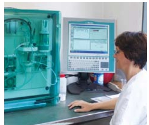
Frau Lecut betreut das ProcessLab System. Links im Bild erkennt man das Analysenmodul mit Komponenten zur Cyanid-Messung, rechts im Bild die Bedieneinheit.
