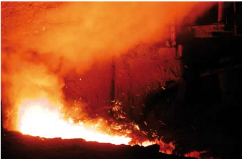
Flüssiges Roheisen fließt aus dem Roheisenstich.
