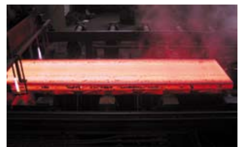
Eine rotglühende Bramme verlässt die Brammenstrangiessanlage.
