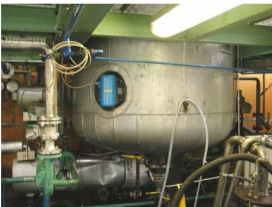
Schallsensor in einem Polymerisationsreaktor
