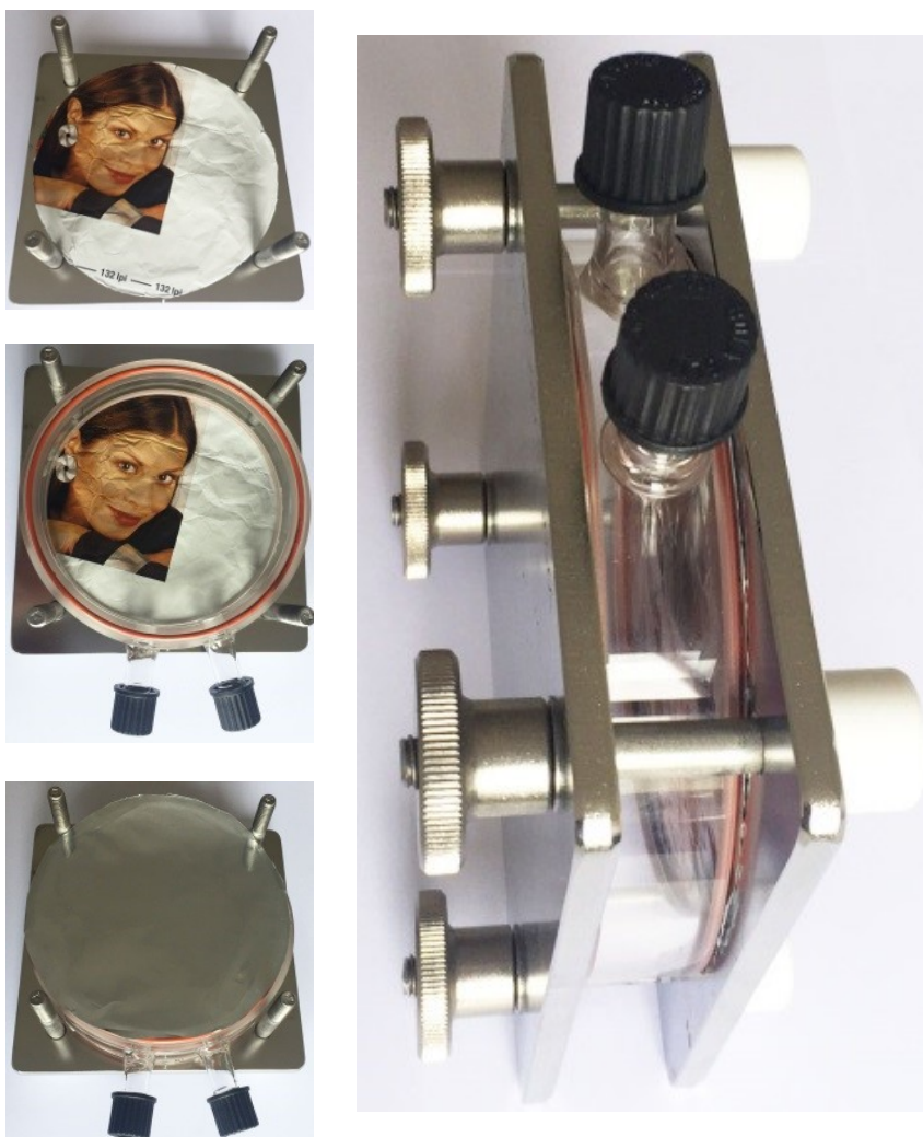
Abb. 3: Die Kombi-Migrationszelle Sieg-Mi-Flex aus einem Glas-Mittelring und einem Edelstahl-Fixierplatten-Set ist temperaturbeständig von -15°C bis 130°C und druckdicht bis 4 bar.
