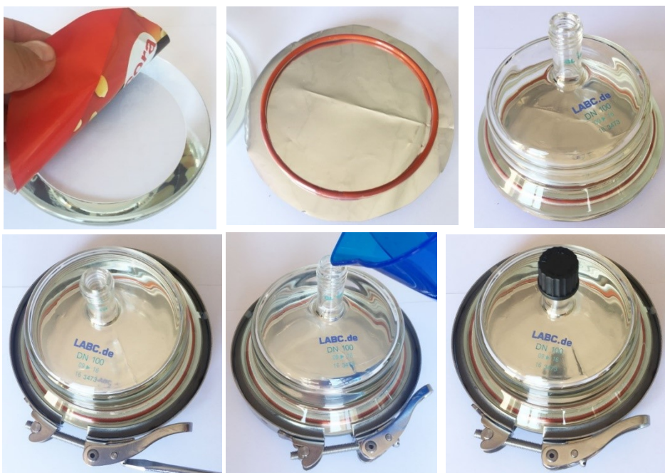
Abb. 2: Das Migrationszellen System: MigraCubicle GL18z MC 150 ist temperaturbeständig bis ca. 70°C und druckdicht bis ca. 0,3 bar.
