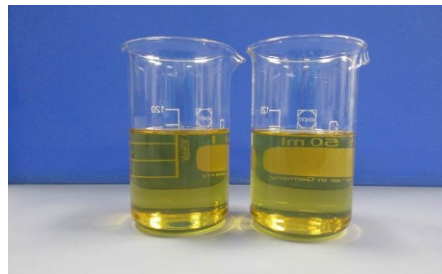
Abb. 1: Aufnahme von frischer und gebrauchter Kühlflüssigkeit vom Typ B. (links: frisch, rechts: gebraucht)
