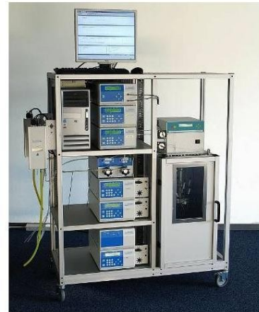
Abb.4: CSEP® C9116 SMB Anlage der Knauer GmbH, Berlin zum Arbeiten im semi-präparativen Bereich.
