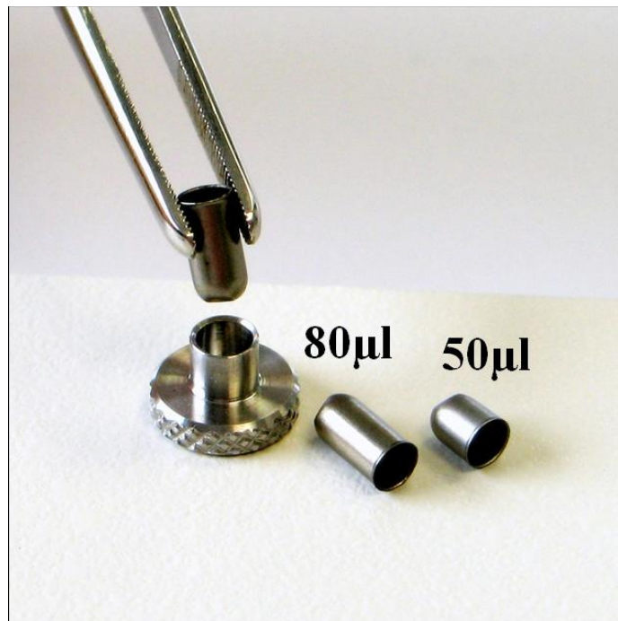
Abbildung 1: Probengefäße (ECO cups) für die Pyrolyse EGA/PY-3030D mit einem Fassungsvermögen von 80 µl und 50 µl.
