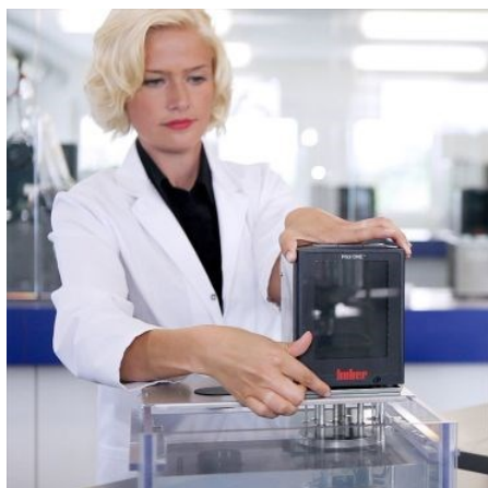
Abb.3: Der neue Touchscreen-Regler Pilot ONE überzeugt mit seiner einzigartigen Plug & Play-Technik, die sich einfach bedienen lässt und einen Austausch der Regler-Module erlaubt.
