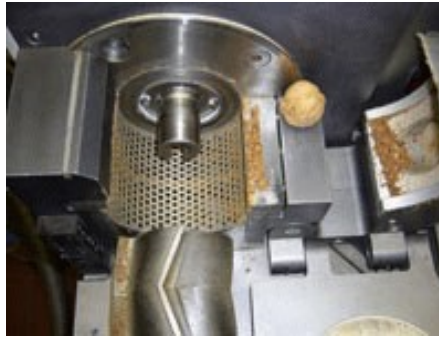
Abb. 3: der Blick in die geöffnete Mahlkammer zeigt einen optimalen Durchsatz der Wahnüsse
