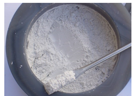
Abb. 3: 100 g Quarzsand 5 min gemahlen, P-6, 250 ml Achatgarnitur, 20 mm Kugeln
