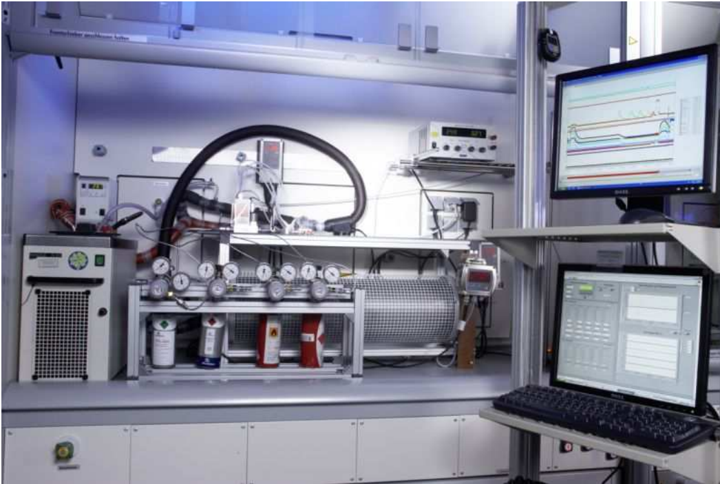
Abbildung 5: Um Gassensoren unter Realbedingungen zu testen, werden in einer Gasmischanlage Schadgase wie Kohlenmonoxid, Schwefeldioxid u.a. gemischt und der Abgasstrom schließlich auf 200-300 °C erhitzt.
