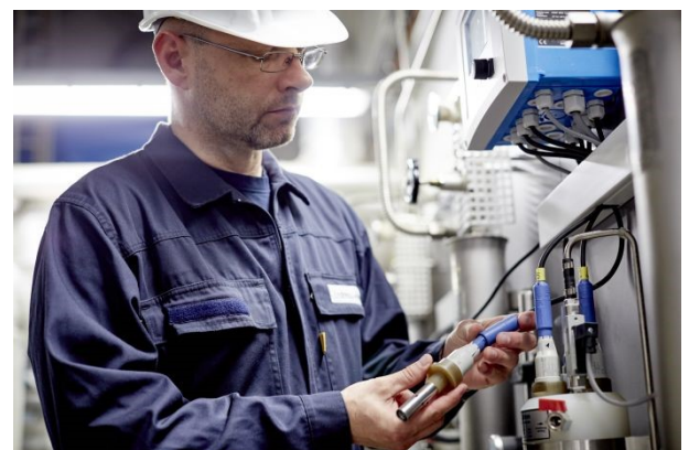
Bild 2: Der konduktive Memosens-Leitfähigkeitssensor Condumax CLS15D misst alle Arten von Leitfähigkeiten auch im niedrigen Messbereich
