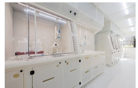
Abb. 2: Die fünf Arbeitsplätze sind absolut metallfrei und bieten Partikelfreiheit auf dem Niveau der Klassen 4 und 5 gemäß DIN EN ISO 14644.
