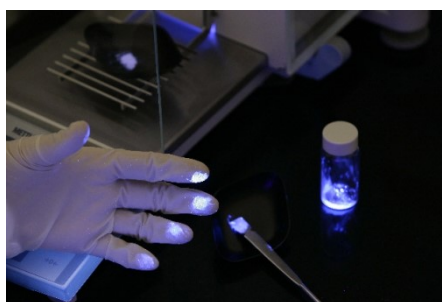
Abb. 1: Typische Kontaminationsverschleppung bei einer Wägeapplikation
