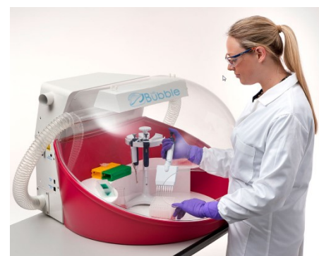
Abb. 4: Schutz vor Expositionen bei Titrationsarbeiten (Lab-Bubble von a1-safetech)
