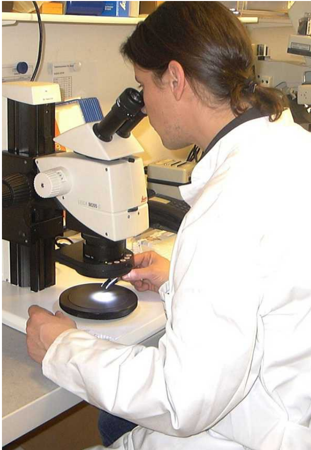
Abbildung 4 : Mit 160facher Vergrößerung prüfen die Mitarbeiter die Linsen unter dem Stereomikroskop auf kleinste Schadstellen
