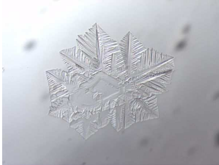
Abbildung 7: Tridymit Dendriten in charakteristischer Ausbildung. Glaseinschluss, Durchlicht Hellfeld + schiefe Beleuchtung zur Kontraststeigerung, HC PL Fluotar 10x Pol, Bildbreite: 1 mm.
