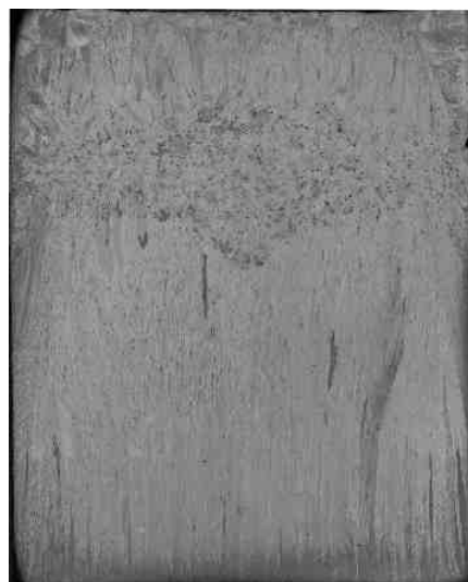
Abb 6: Fotografische Aufnahme des Längsschliffes einer Sn-38M.%Pb-Legierung. Ein zeitlich moduliertes Magnetfeld wurde während der Erstarrung zugeschaltet.
