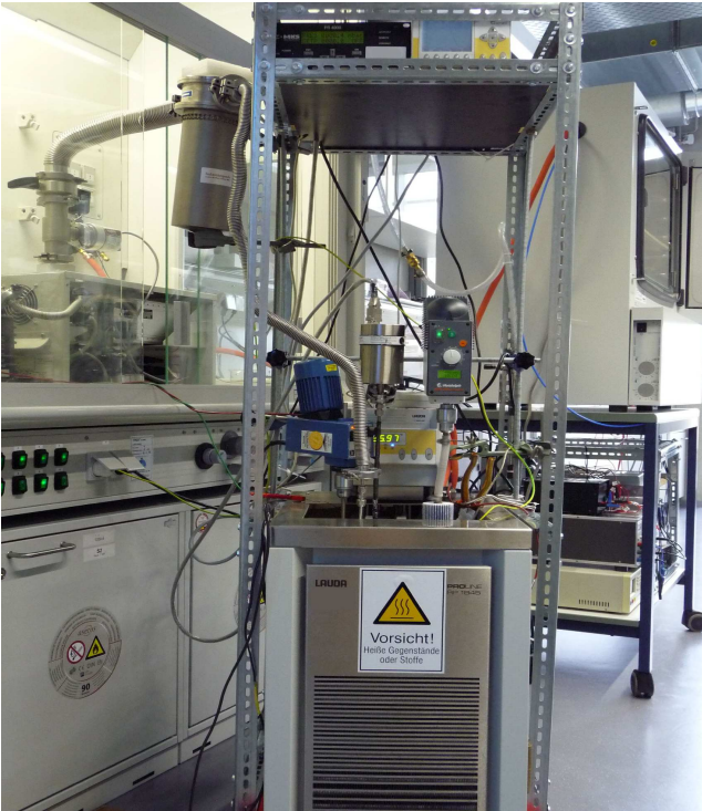
Abbildung 2: Messaufbau zur dynamischen Bestimmung von Dampfdrücken. Die Messzelle befindet sich im Temperierbad des Thermostaten. Weitere Komponenten sind: Druckaufnehmer, Rührwerke, Vakuumpumpenstand mit Drehschieber- und Turbopumpe.
