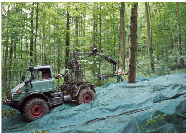
Abbildung 1: Einsatz eines mechanischen Schüttlers zur Ernte von Wildkirschen in einem zugelassenen Bestand.
