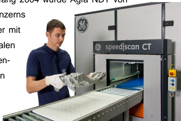
Abb. 3 Im Ahrensburger GE Werk wurde 2012 die erste Serienanlage für schnelle dreidimensionale CT-Untersuchungen beispielsweise von Automobil-Gussteilen gebaut.
