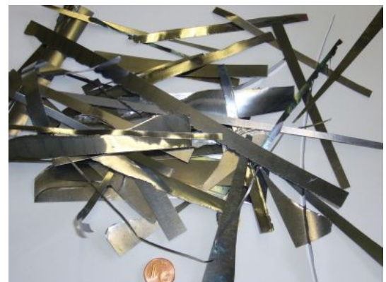
Abb.2: gewalztes Vanadium für Proben-aufbereitung
