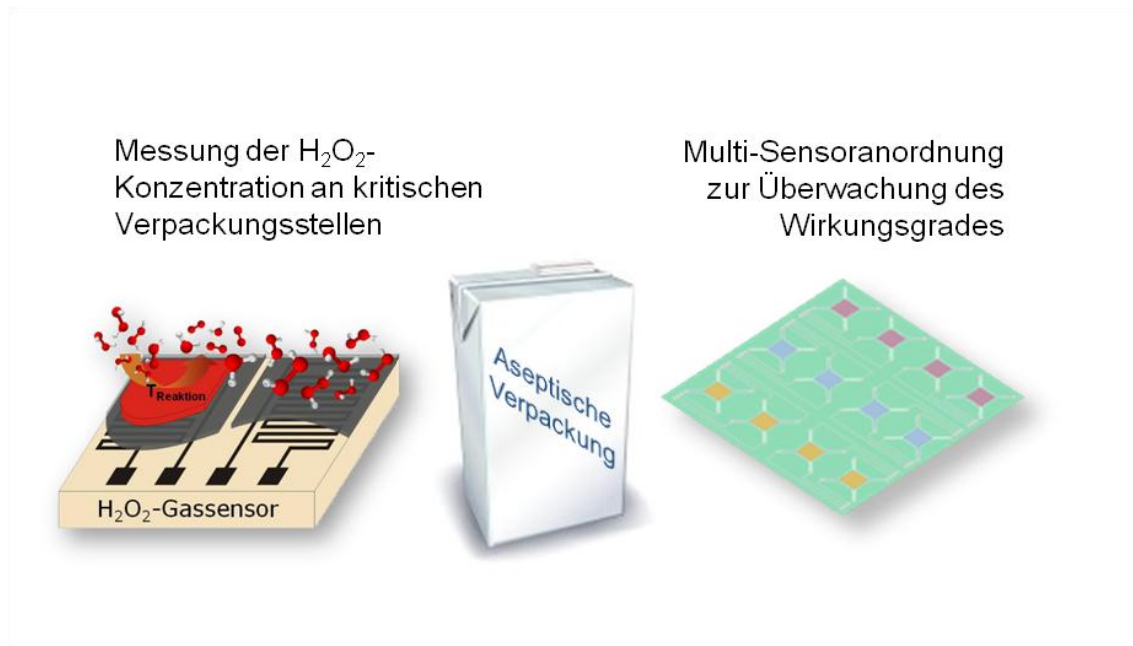
Abbildung 6 Zwei unterschiedliche Sensorkonzepte zur Validierung der H 2 O 2 -Sterilisation in Lebensmittelverpackungen (schematisch); links ist der kalorimetrische Sensorchip in Differenzanordnung zu erkennen, rechts die Multi-Sensoranordnung.
