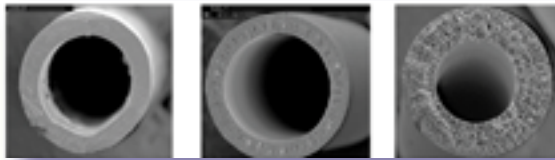
Abb. 10: Kapillarmembranen aus \alpha - \text{Al}_2\text{O}_3 mit verschiedenen Wandstrukturen und Außendurchmessern von 0,6 mm (links), 0,8 mm (Mitte) bzw. 1,1 mm (rechts), Wandstärken zwischen 0,1 und 0,25 mm.
