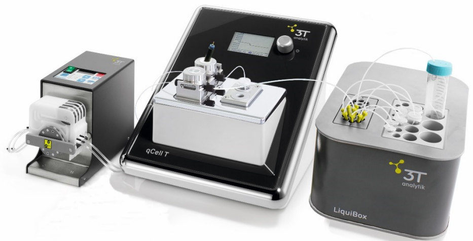
Abb. 1: Das qCell T auto setup von 3T analytik in der 2-Kanal Konfiguration mit Potentiostatenanschluss für kombinierte elektrochemische sowie QCM-D Messungen. Es beinhaltet die voll automatisierte Proben- und Temperaturregelungstechnik.
