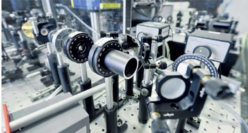
Abb. 4b: Detailaufnahme: Detektionseinheit für die THz-Pulse – im Vordergrund dieses so genannten Electro-Optical-Samplings sind die Polarisatoren (mit einer 360°-Einteilung) zu sehen, im Hintergrund ein Photodetektor. Die Polarisationsdrehung wird durch das elektrische Feld des THz-Pulses mittels eines „Probelasers“ nachgewiesen.
