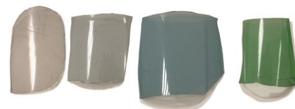
Abb. 2: Kunststoffzuschnitte aus PET-Flaschen
