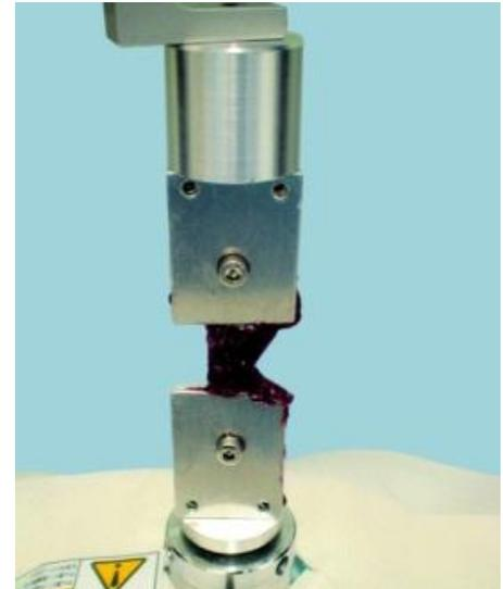
Abb. 3: Eingespannte Schweineleberprobe
