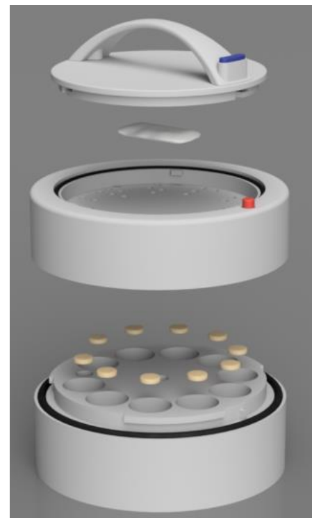
Abb. 2: Messkammer mit 10-fach Probenaufnahme integrierter Temperierung und Überwachung, sowie Option zur Feuchteconditionierung
