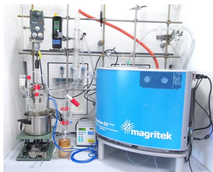
Abb. 2: Laboraufbau für die Überwachung der Auflösungskinetik von Additiven in Trialkoxysilanen.
