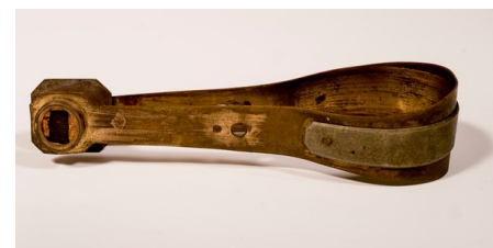
Abb. 5: Diese Zange besitzt an beiden Enden je einen speziell geschnittenen Turmalinkristall (dunkles Rechteck). Der eine Kristall erzeugt polarisiertes Licht, der andere dient als Analysator. Die Turmalinzange ist ein einfaches Instrument, um die optischen Eigenschaften von Mineralen zu untersuchen, die man zur Betrachtung zwischen die beiden Kristalle bringt. (Foto: Kramer; RUB)
