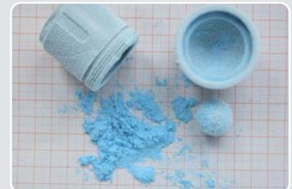
Ergebnis der Zerkleinerung ist ein homogenes Pulver
