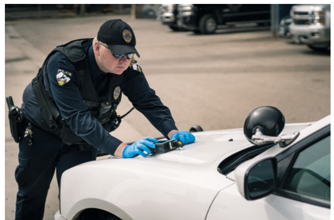
Abbildung 1. Mit dem Rechtwinkel-Aufsatz lassen sich Messungen auf Oberflächen durchführen.
