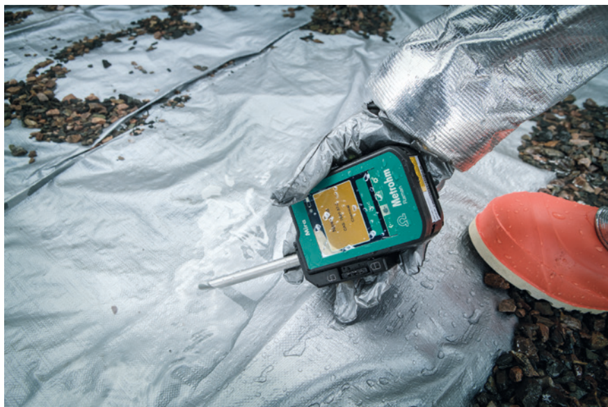
Abbildung 2. Mit dem Tastkopfsondenaufsatz können Substanzen in direktem Kontakt mit der Sonde gemessen werden, sodass die Einhaltung eines bestimmten Abstands nicht weiter beachtet werden muss.
