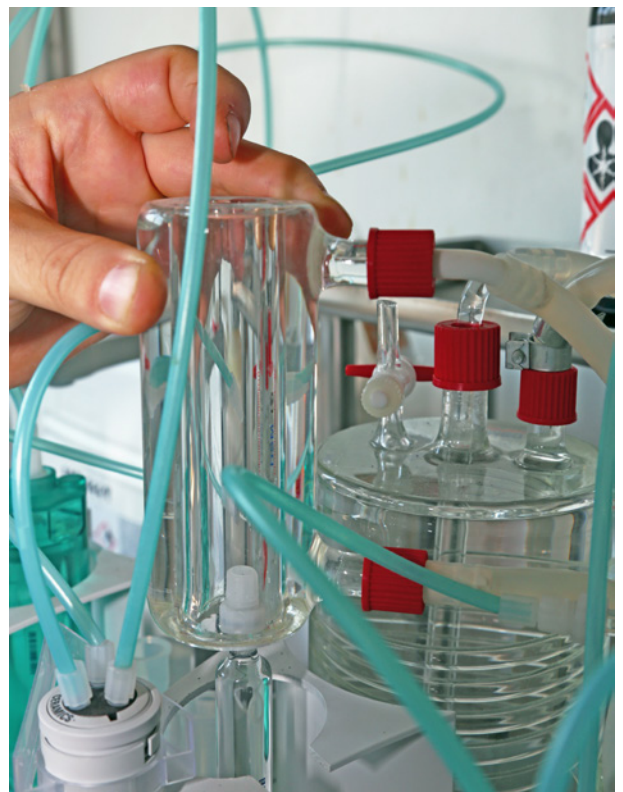
Abbildung 3. Bevor Acetylierungslösung und Titriermittel in das Titriergefäß gelangen, werden sie mithilfe thermostatisierter Gefässe wie dem hier abgebildeten auf 26 °C erwärmt.
