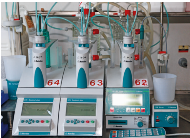
Abbildung 2. Der Titrino und die zwei Dosimaten bilden das Herzstück der bei Aliancys verwendeten Messapparatur.
