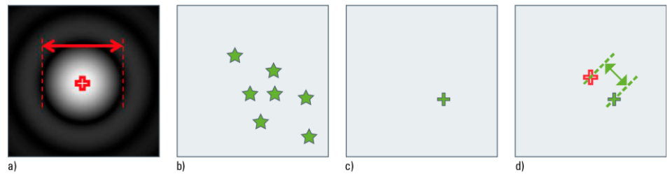
Abb. 7: Lokalisierungsgenauigkeit eines singulären Emitters. a) theoretische Punktverwaschungsfunktion eines singulären Emitters, der sich in der Mitte des Bildes befindet (rotes Kreuz). b) Aufnahme einer Serie einzelner Emissionen. c) Koordinaten des Mittelpunktes der am besten passenden PSF (grünes Kreuz). d) Darstellung des Fehlers beim hier betrachteten Beispiel. Der mittlere Fehler ist umgekehrt proportional zur Wurzel aus der Zahl der Photonen, die zur Messung beitragen.
