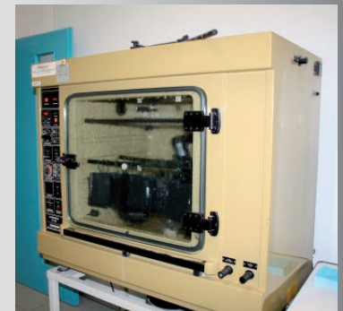
Die Lacke werden auf verschiedenste Witterungen getestet.
