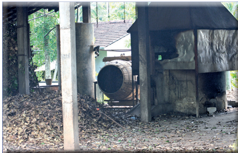
Abbildung 13: Zimtöl-Destillation aus den Blättern des Zimtbaumes (I).
