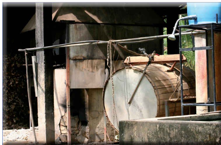
Abbildung 14: Zimtöl-Destillation aus den Blättern des Zimtbaumes (II).
