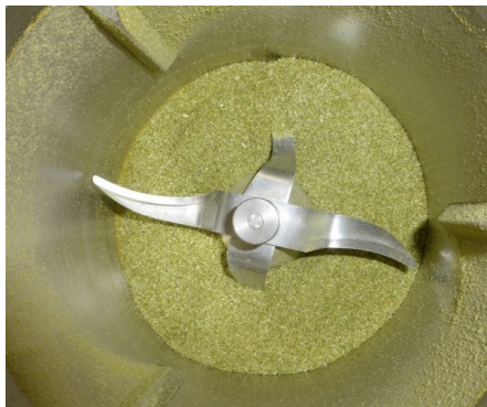
Abb. 2: Hopfen gemahlen bei 4.000 U/min, Mahldauer 15 Sekunden
