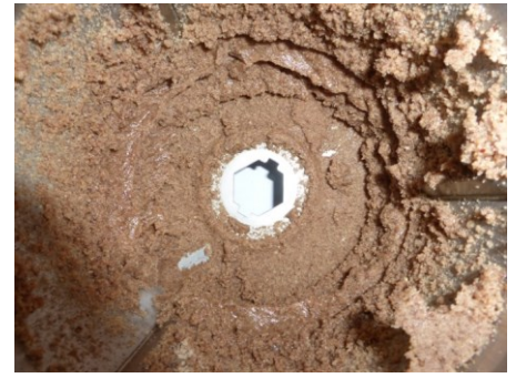
Abb. 6: Haselnüsse nach 30 Sekunden Mahlung im Mahlbehälter aus rostfreiem Stahl
