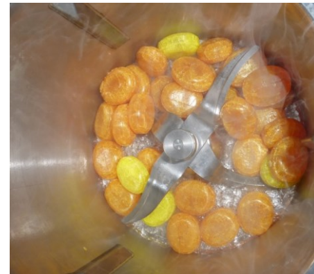
Abb. 3: Fruchtbonbons mit flüssigem Kern, versprödet in Stickstoff
