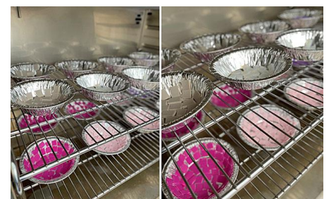
Abb. 2: Proben beim Erhitzen im Muffelofen
