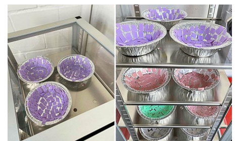
Abb. 3: Proben zur Entfeuchtung im Trockenschrank
