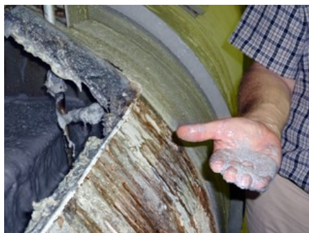
Deinkingschlamm bei einer Flotation zur Abtrennung von Druckfarben im Recyclingprozess
