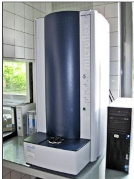
Abb.1 MALDI-TOF-Massenspektrometer des CVUA Freiburg
