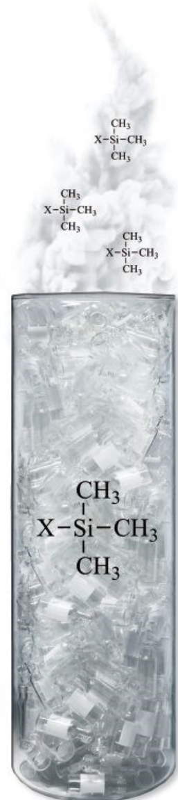
Abb. 2: Silanisierung von Glas
