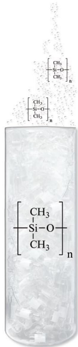
Abb. 4: Silikonisierung von Glas
