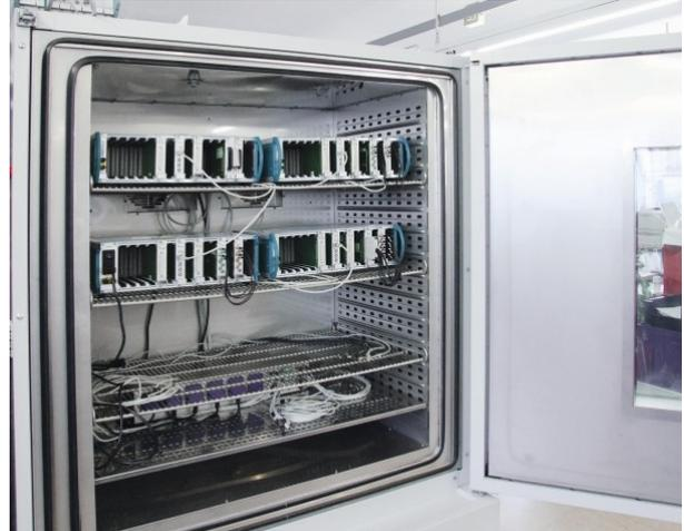
Kraus Hardware testet in der Kälte- Wärmetestkammer auch vom Kunden gelieferte Baugruppen. Bei der Messprüfung wird erfasst, bei welcher Temperatur welche Fehler auftreten. Dies gibt Hinweise über mögliche Ursachen. Mehrere hundert Prüfungen dieser Art führt das Unternehmen pro Jahr im Kundenauftrag durch.
