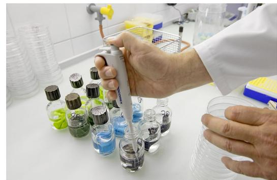
Abb.2: Pro Jahr werden bei SANITIZED rund 20.000 mikrobiologische Tests nach standardisierten Methoden durchgeführt. Um die genaue Keimzahl zu bestimmen, werden mit der Mikropipette die Verdünnungsreihen ausgeplattet.
