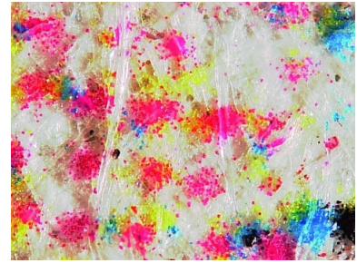
Abb.5: Tonerpartikel und Papierfasern einer Fälschung. Foto: © Deutsche Bundesbank
