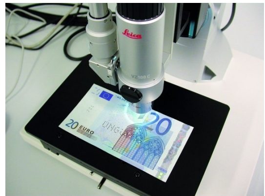
Abb.2: Das Leica DVM5000 bei der Analyse einer Banknote. Mit Hilfe der hohen Vergrößerungen, der flexiblen Zoom-Optiken und der hohen Schärfentiefe können die Experten herausfinden, wie Falschgeld hergestellt wurde und zu welcher bereits bekannten Handschrift eine Fälschung passt. Foto: © Deutsche Bundesbank
