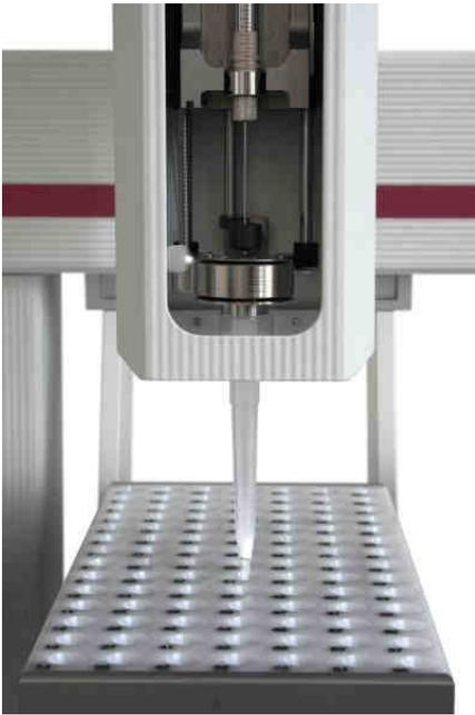
Abbildung 2: Probenhalter des Multi Purpose Samplers (MPS)
